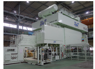
自動車のボディを作るプレス機械。 大きなものは長さ50m近くになることも!
